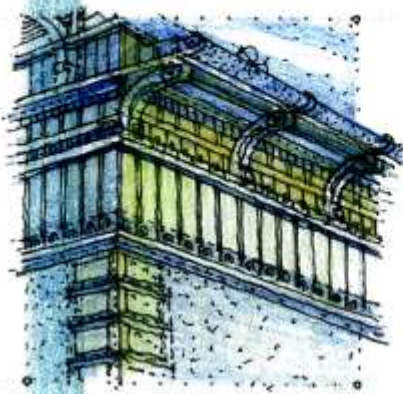
Dekoracyjna faseta; pod okapem rysie, listwy, wsporniki, deskowanie
